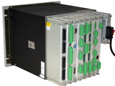
Figure 4: Mini Rack Back View – I/O Modules
